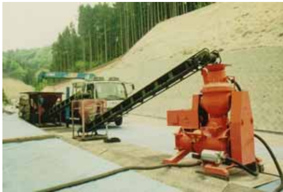
吹付機械（一般の吹付機械設備のプラント）
